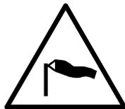
Gefahr des übermäßigen Ausschwenkens: Umstehende könnten gequetscht oder erschlagen werden. Bei starken Windereignissen ist das Heben mit dem Kran untersagt!
